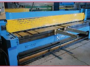
NIAGARA POWER SHEAR MODEL NO 410, 10' X 14 GAUGE CAPACITY
