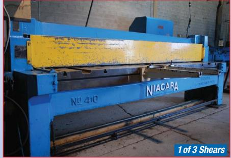
NIAGARA POWER SHEAR MODEL NO 410, 10' X 14 GAUGE CAPACITY
